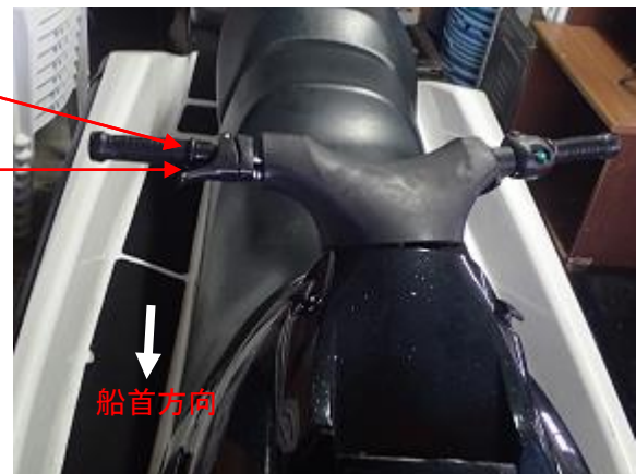
写真2 本船のスロットルレバー
