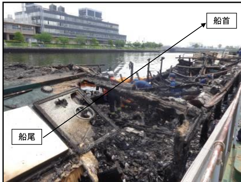
写真1 本船の焼損状況（右舷船尾方より）
