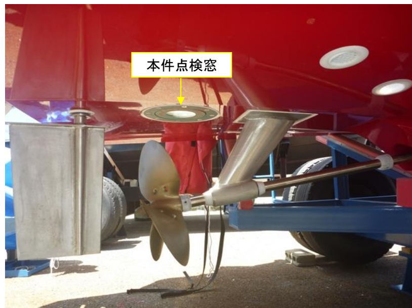
写真2 船底から見た本件点検窓の状況
