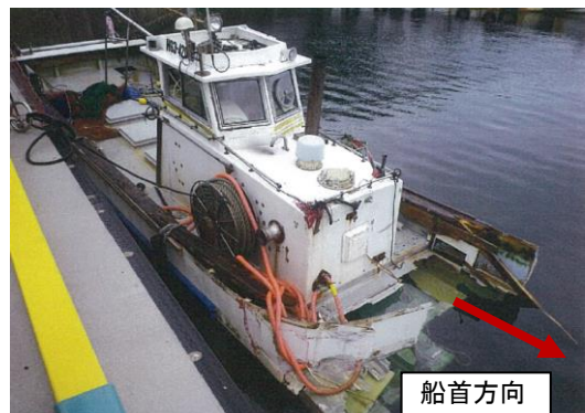
写真5 B船の分断した船尾部
