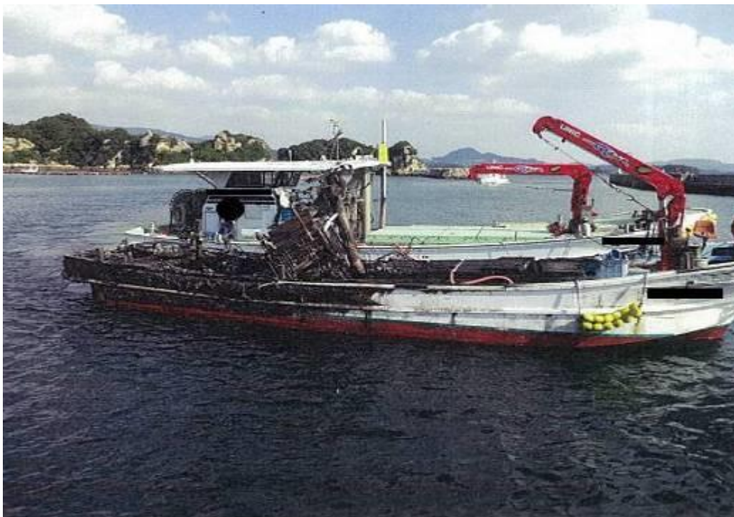
写真1 本船の焼損状況
