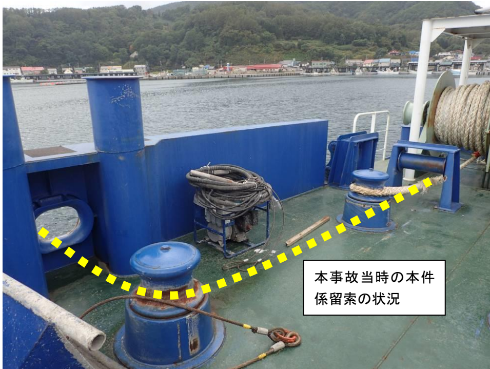
写真4 B船右舷船首側係留索及びウインチの状況
