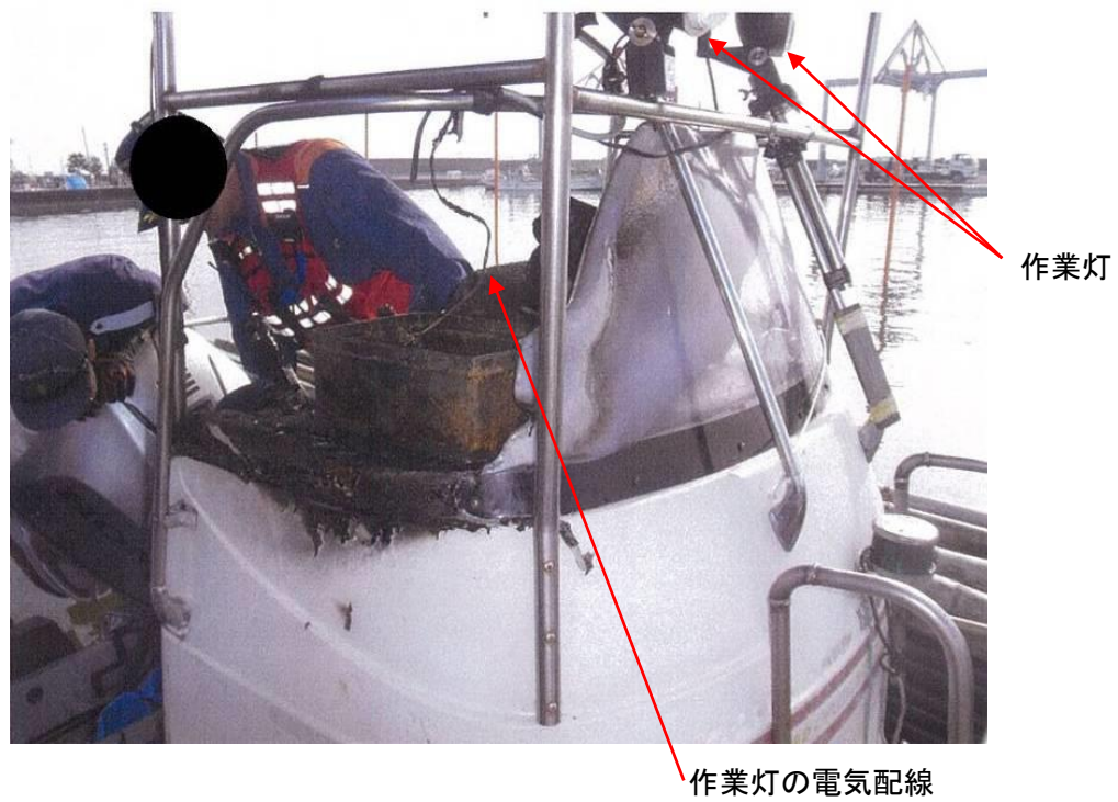
写真1 本船の焼損状況
