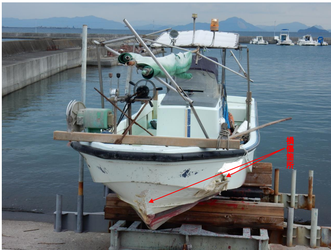
写真1 本船の損傷状況（船首部）
