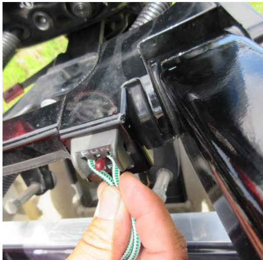
写真2 緊急エンジン停止コードを使用したときの状況
