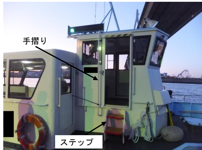
写真① 操舵室右舷側の出入口
