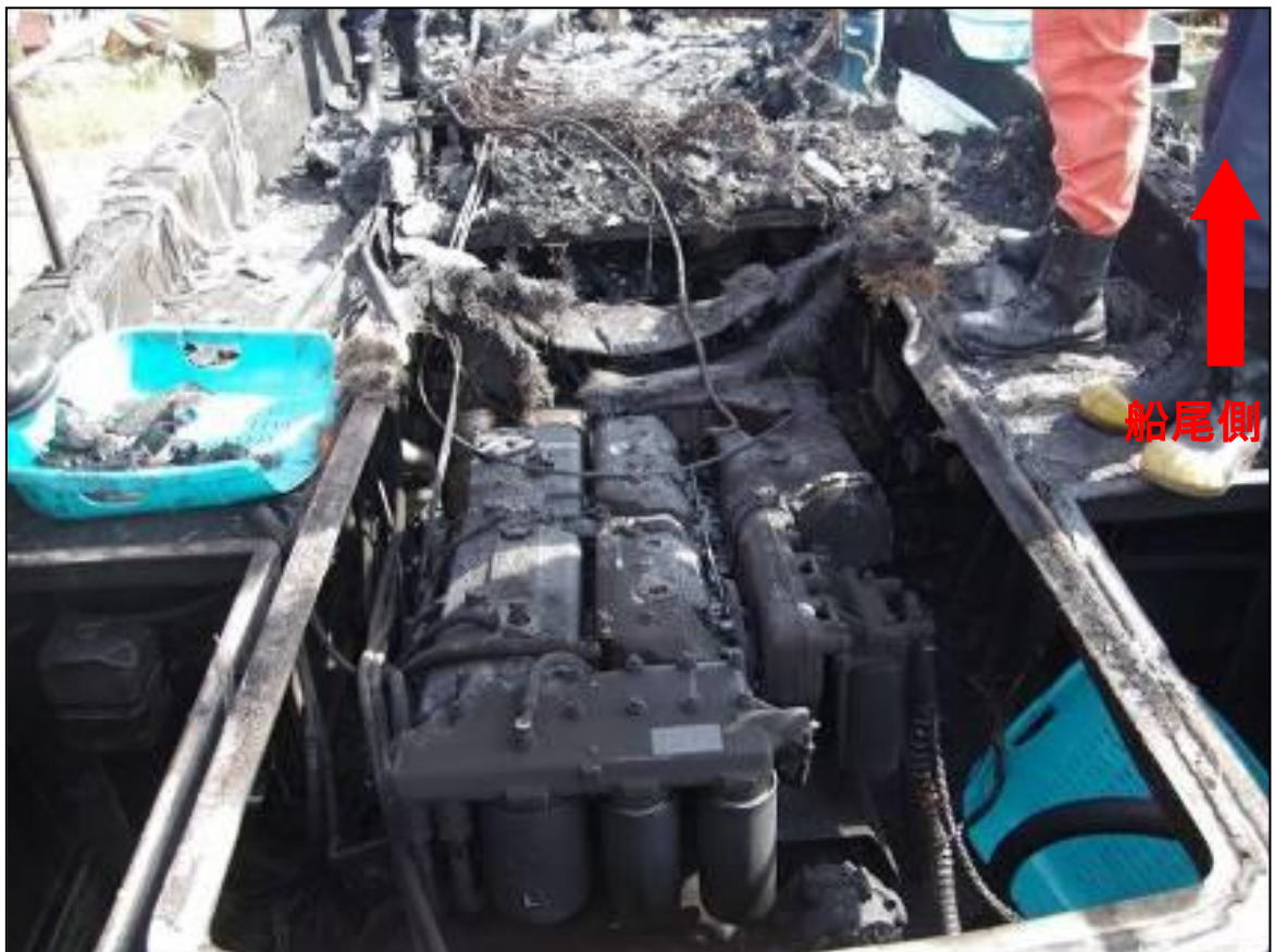
写真2 本船の焼損状況（機関室周辺）
