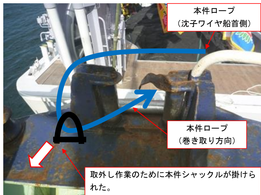
写真2 船首部先端のガイドローラの状況
