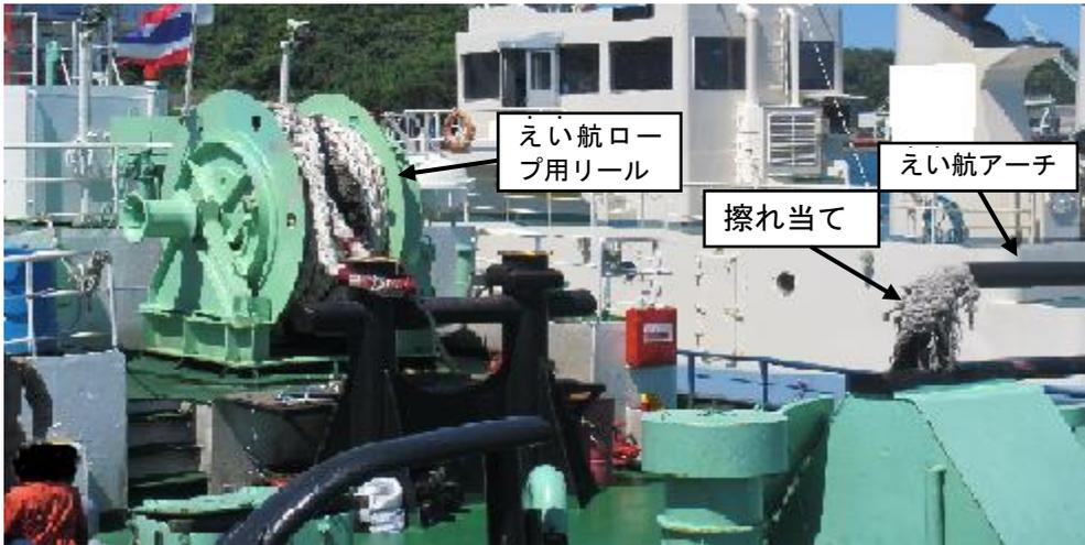
写真2 えい航ロープの切断部
