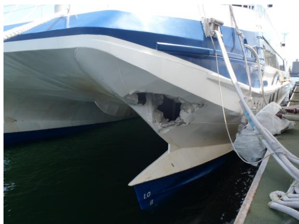
写真2 左舷側船体の船首部外板の破口状況
