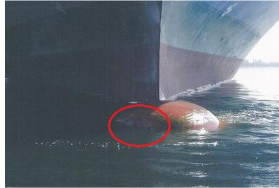
写真4 ビットの陥没状況
