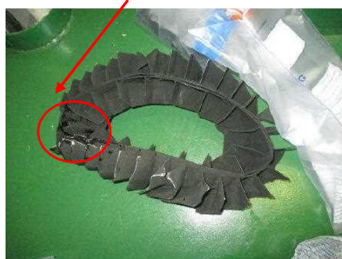
写真2.3-2 二次空気ノズルの曲損状況等
