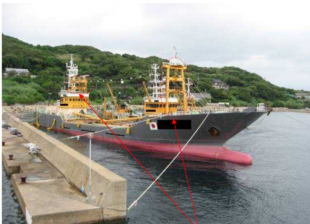
ケーブルクレーンが渡された櫓
