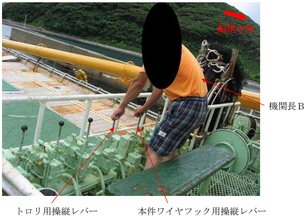
写真5 ケーブルクレーンの操縦レバーの操作状況
