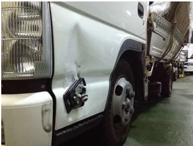
写真2.3-3 横転していた小型トラックの損傷状況
