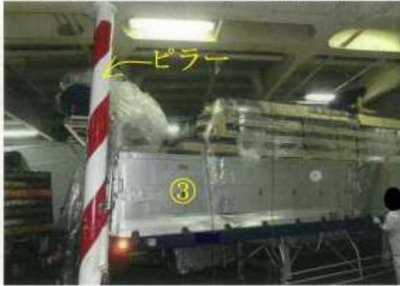
車両③とピラーの接触状況
