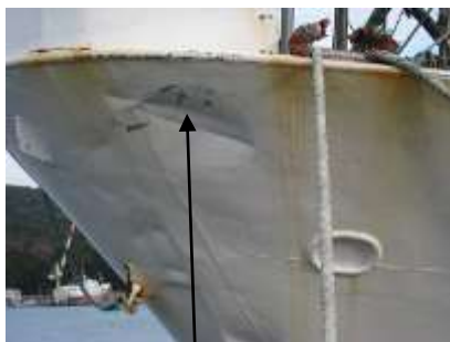
写真6 A船の損傷状況 (船首部)
