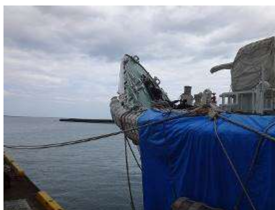
写真2.3-2 上甲板の損傷状況
