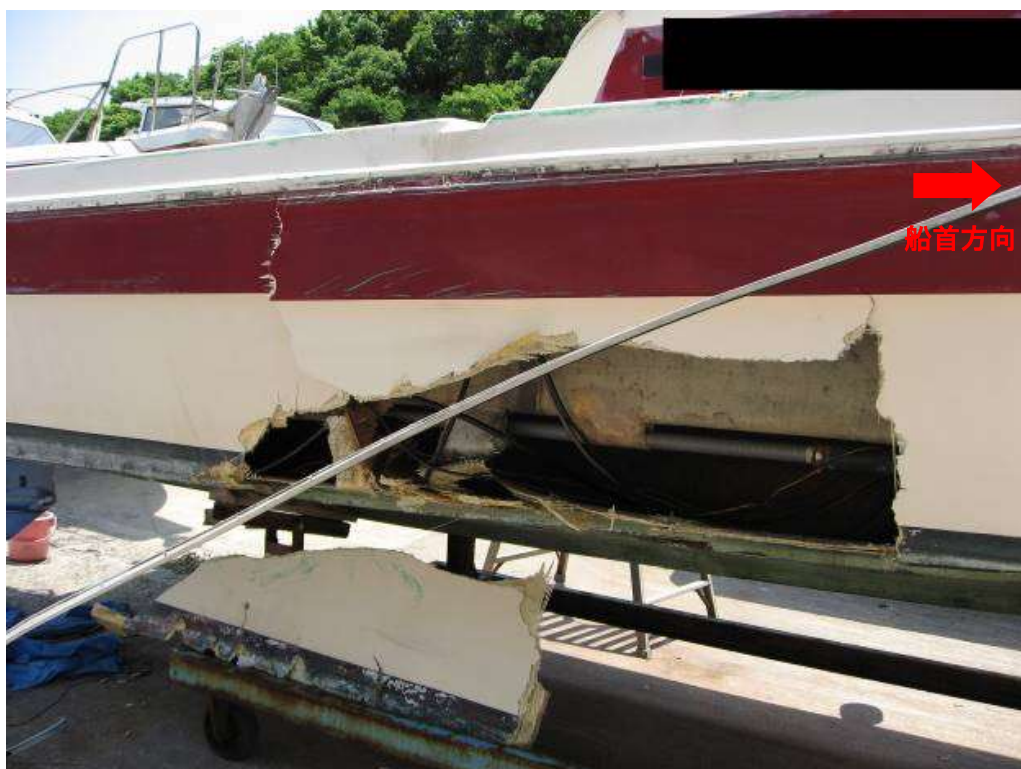
写真4 C船の損傷状況（船体右舷中央部）
