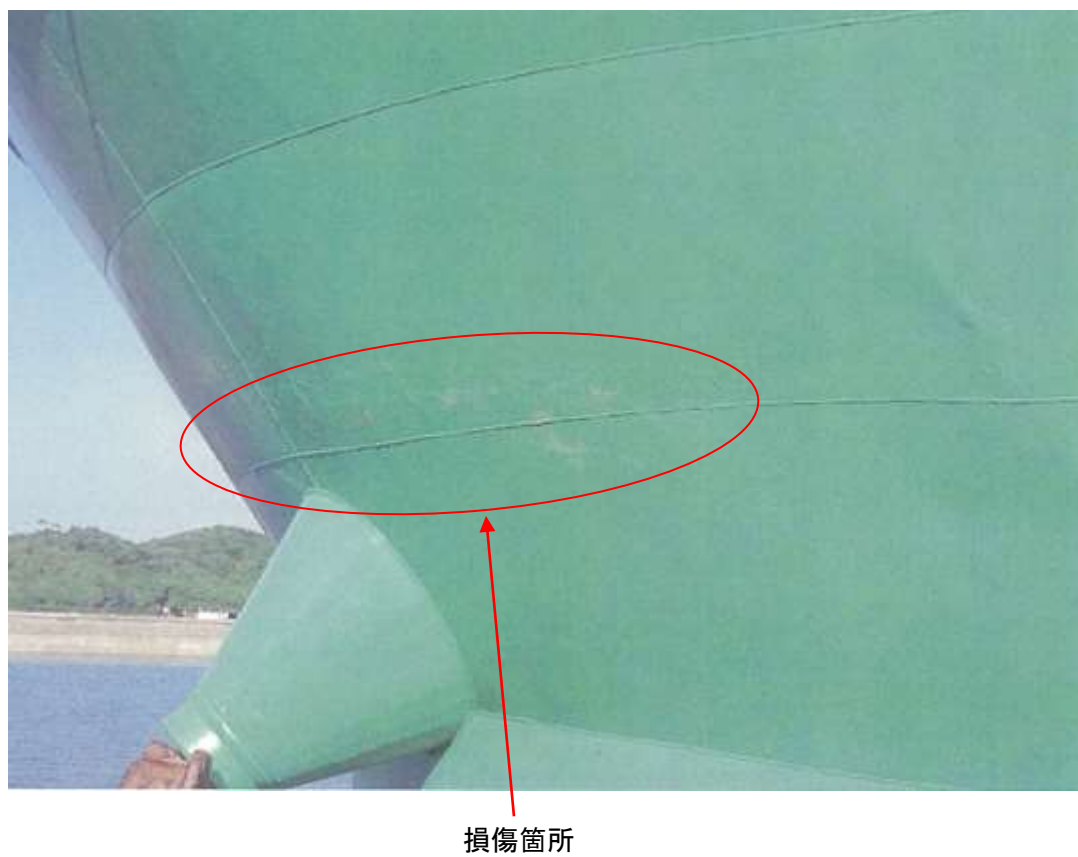
写真2 B船の損傷状況（左舷船首部）
