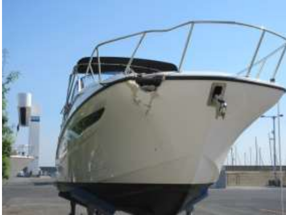
写真 2.3-1 本船の損傷状況 (下方から)
