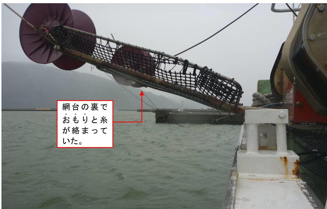
写真2 本件いか釣り機の網台を舷外に倒した状況
