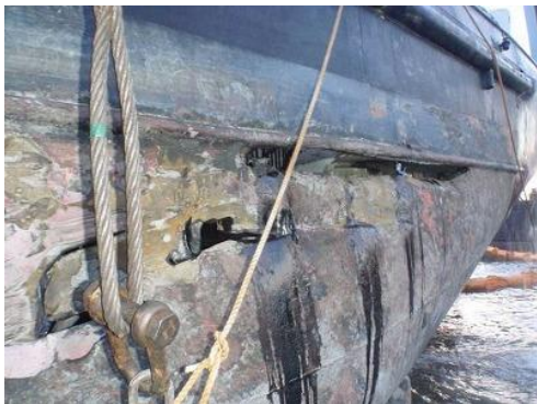
写真5 B船左舷の損傷状況
