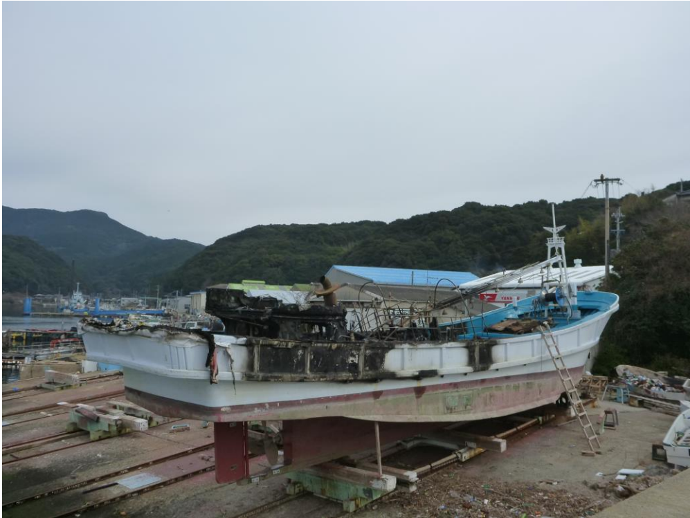
写真1 本船の焼損状況①
