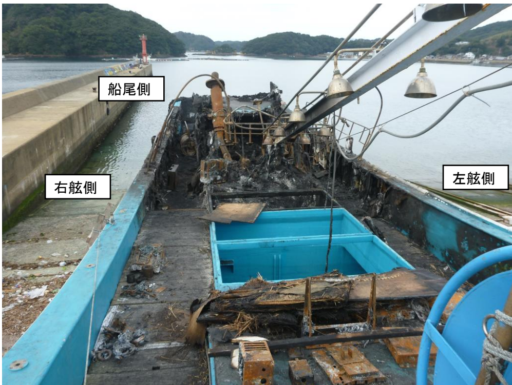
写真2 本船の焼損状況②
