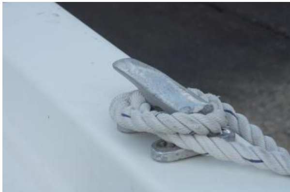
写真② B船（左舷船尾のクリートの折損状況）
