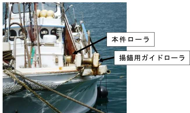
写真3 正船首方から見た揚錨用ガイドローラと本件ローラ
