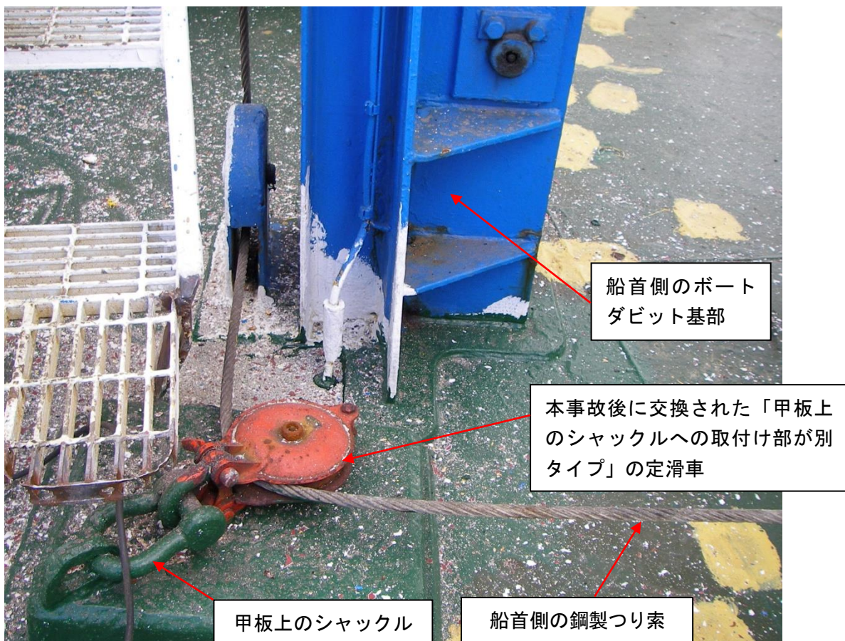
写真3 本事故後に交換された「甲板上のシャックルへの取付け部が別タイプ」の定滑車の状況（2本のポートダビットの中央から船首方を見たところ）
