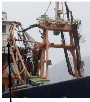
右舷船首部のブーム曲損
