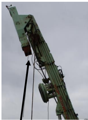
左舷船尾のクレーンのブーム破損
