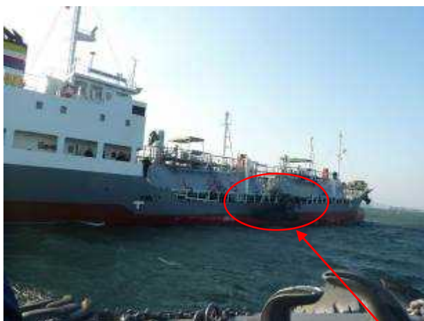
写真3 右舷側焼損状況
