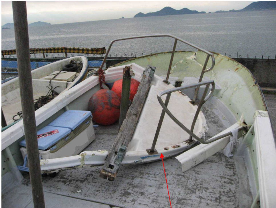
脱落した船首張出部
