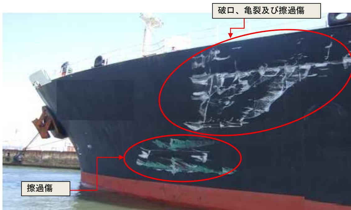
写真1 A船の損傷状況
