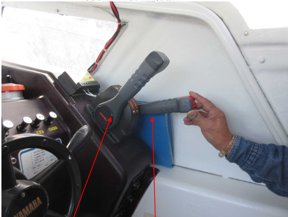
写真2 主機遠隔操縦レバー
