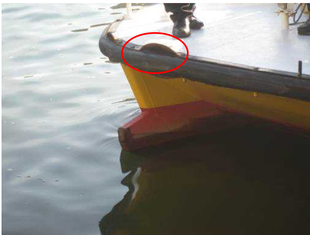
写真1 本船の右舷船首部の凹損
