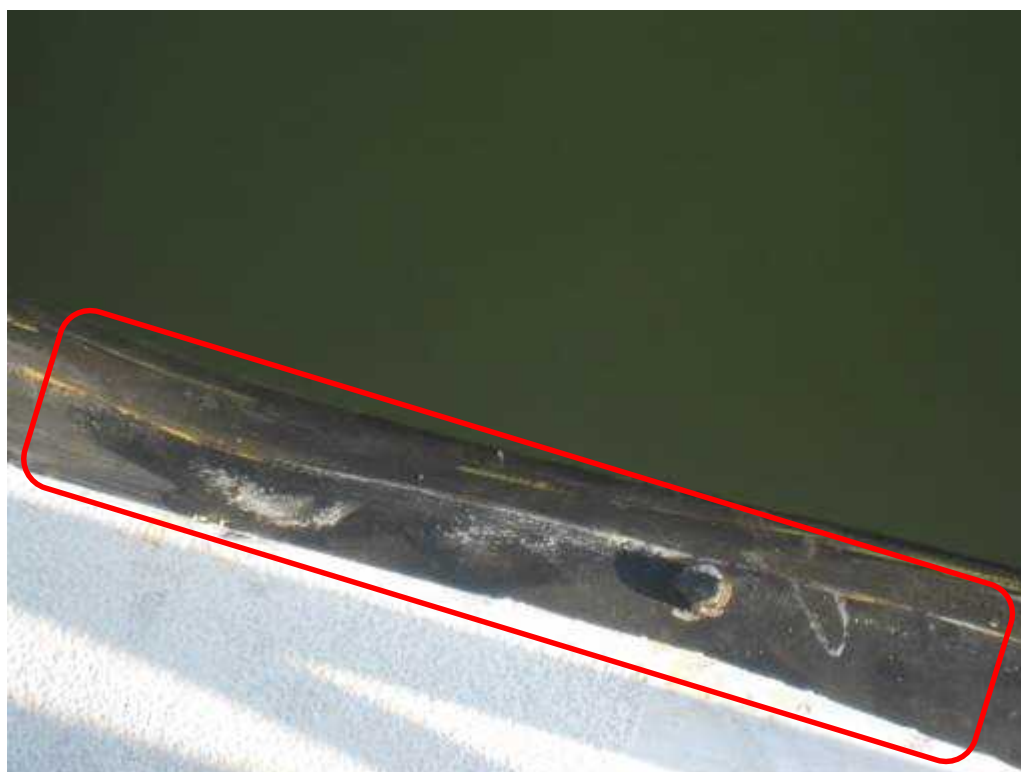
写真2 本船の右舷船尾部の擦過傷
