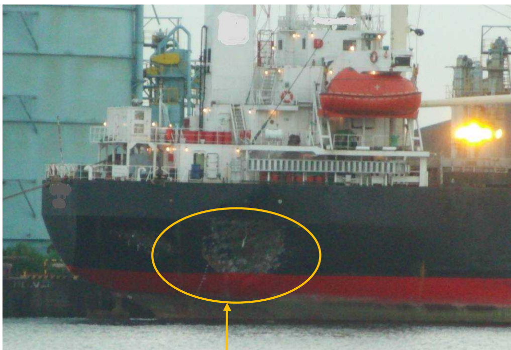
写真1 B船の損傷状況（その1）
