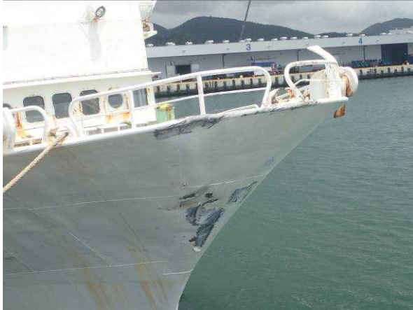
写真 2.3-1 船首部損傷状況
