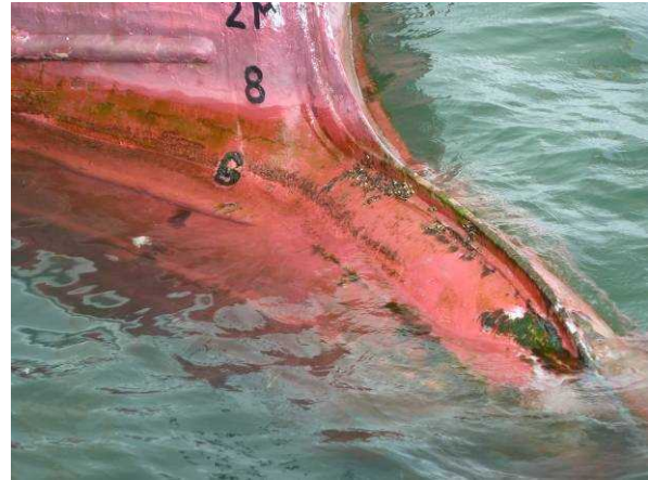
写真 2.3-2 球状船首損傷状況
