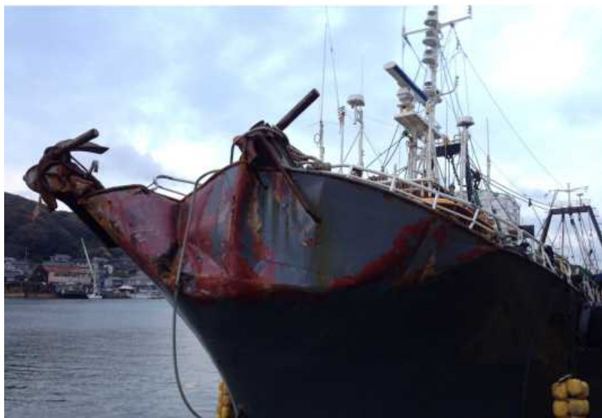
写真2 B船船首部損傷状況
