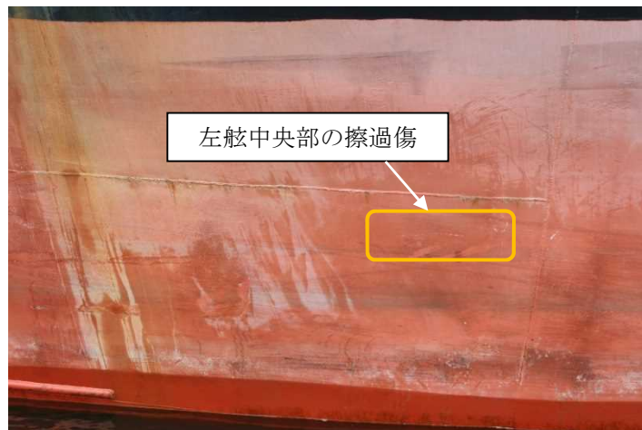
写真 2. 3 - 1 A 船の損傷状況
