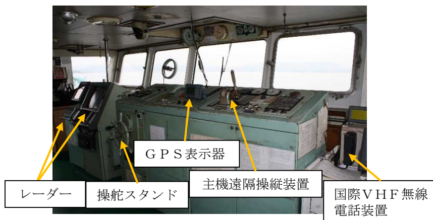
写真 2.5-2 船橋前部の写真
