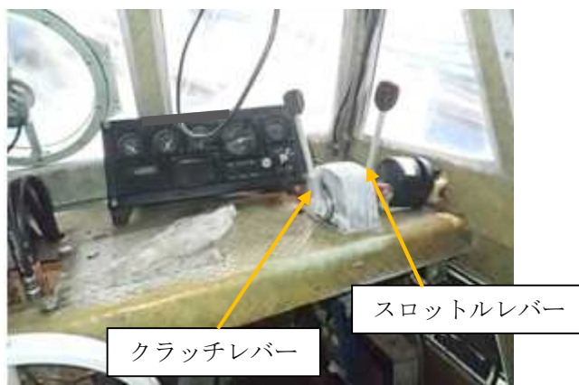
写真2.5-4 主機の遠隔操縦装置の状況 舵板は、舵中央の状態であった。
