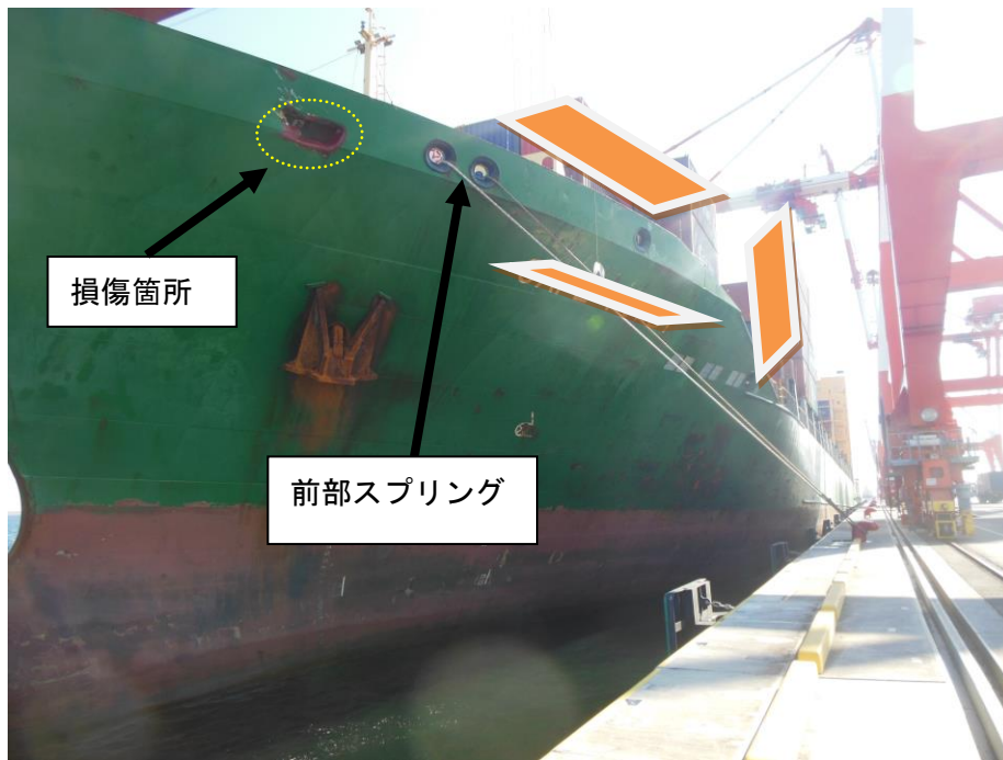
写真1 A船の損傷状況及び前部スプリング
