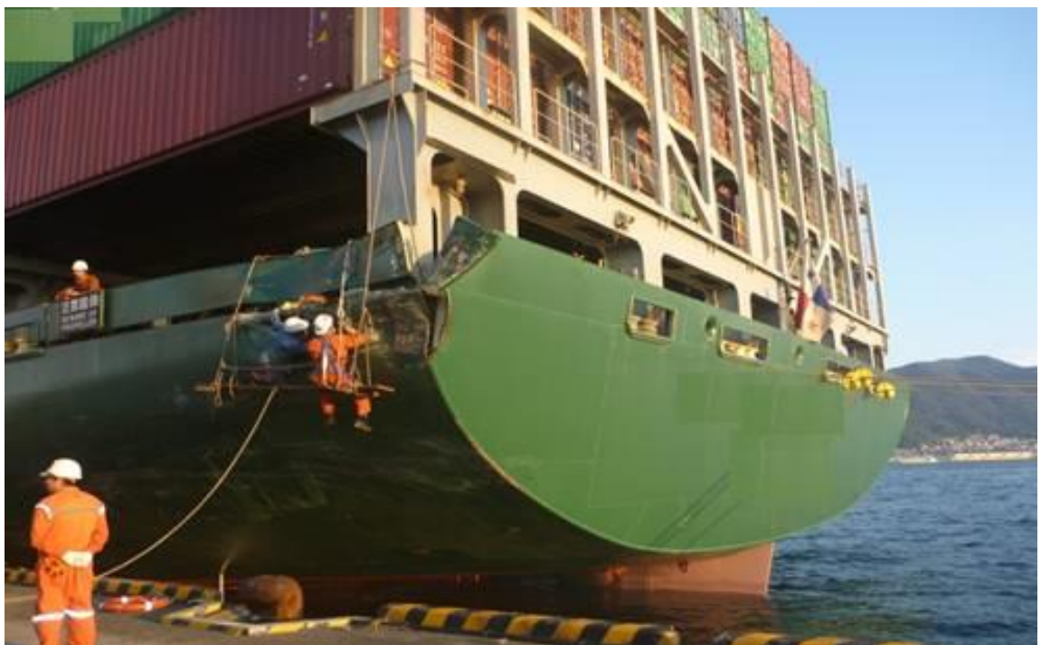
写真2 A船の損傷部
