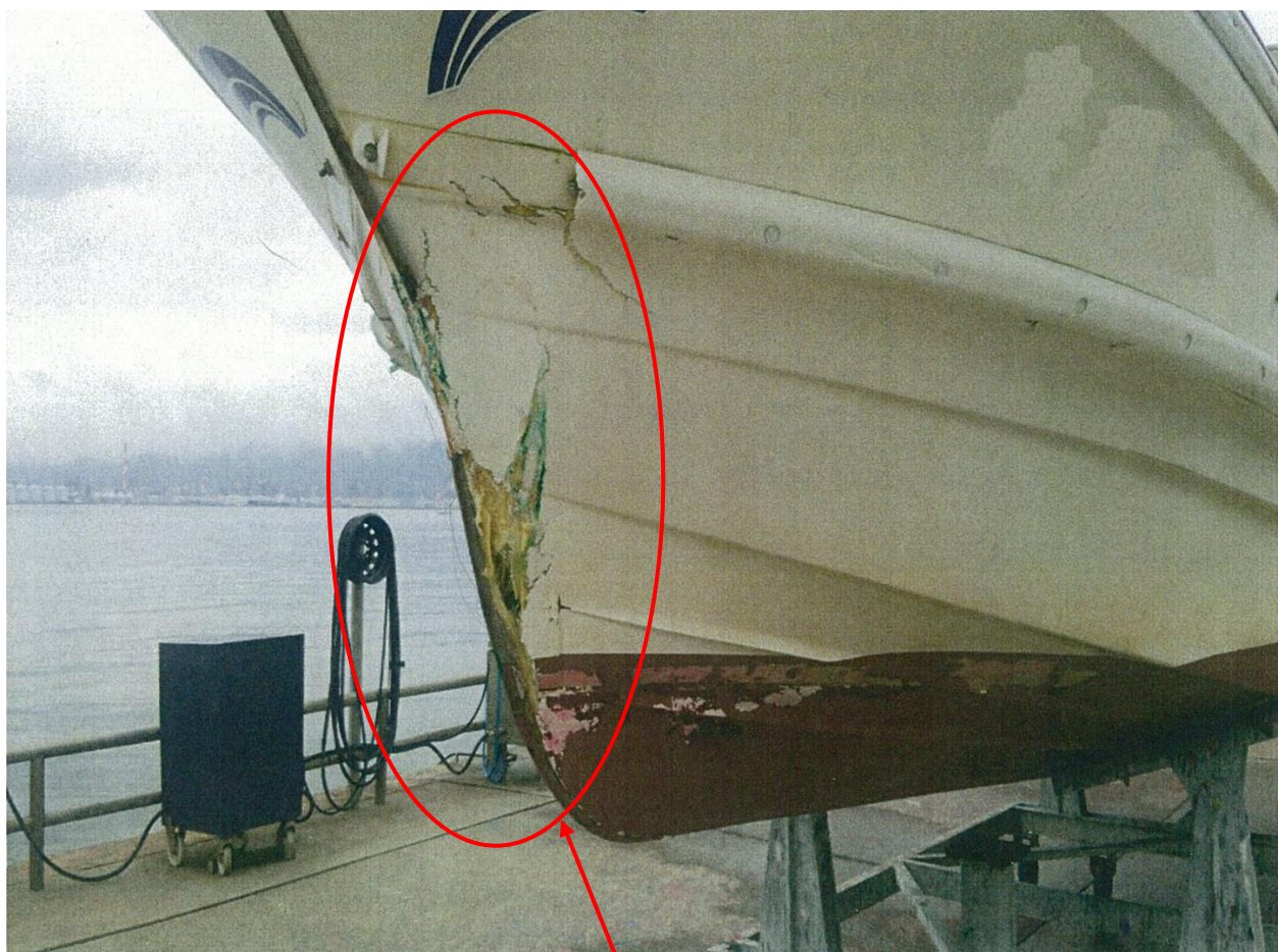
写真1 本船の損傷状況
