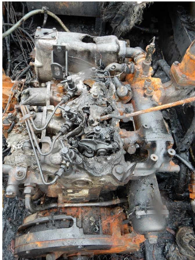
写真3 本事故後の主機焼損状況1 (船首側から)
