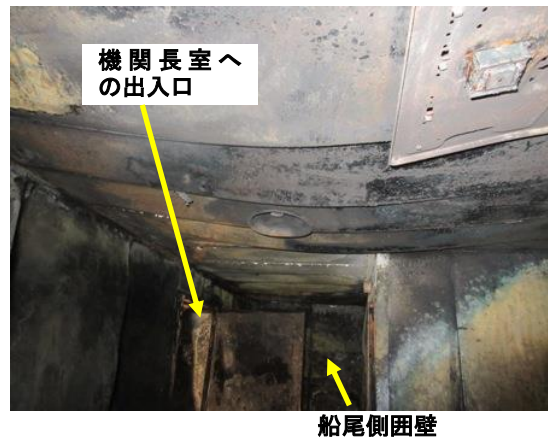
写真6 すずで汚損した機関長室前の通路
