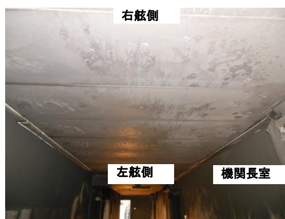
写真6 すずで汚損した機関長室前の通路
