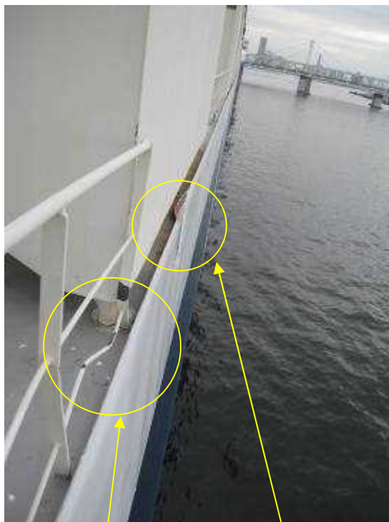
写真4 A船の損傷状況（左舷後部）
