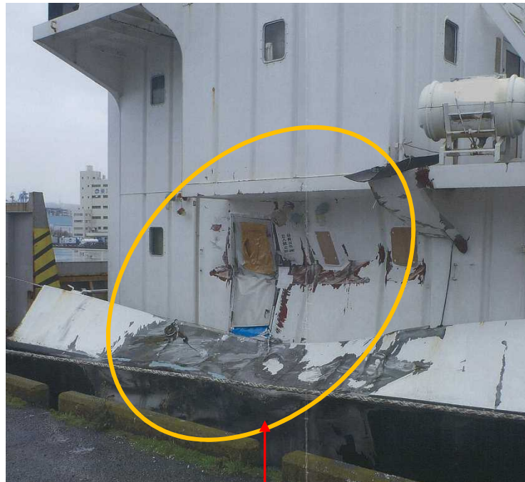
亀裂を伴う凹損
