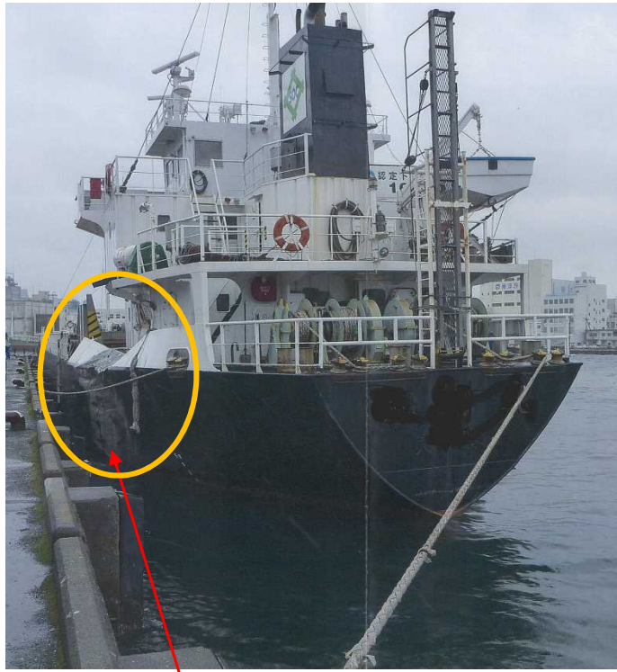
亀裂を伴う凹損
