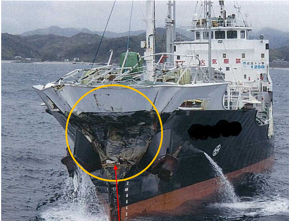
船首の破口を伴う凹損
