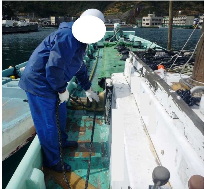
写真2 船長の揚錨作業体勢
