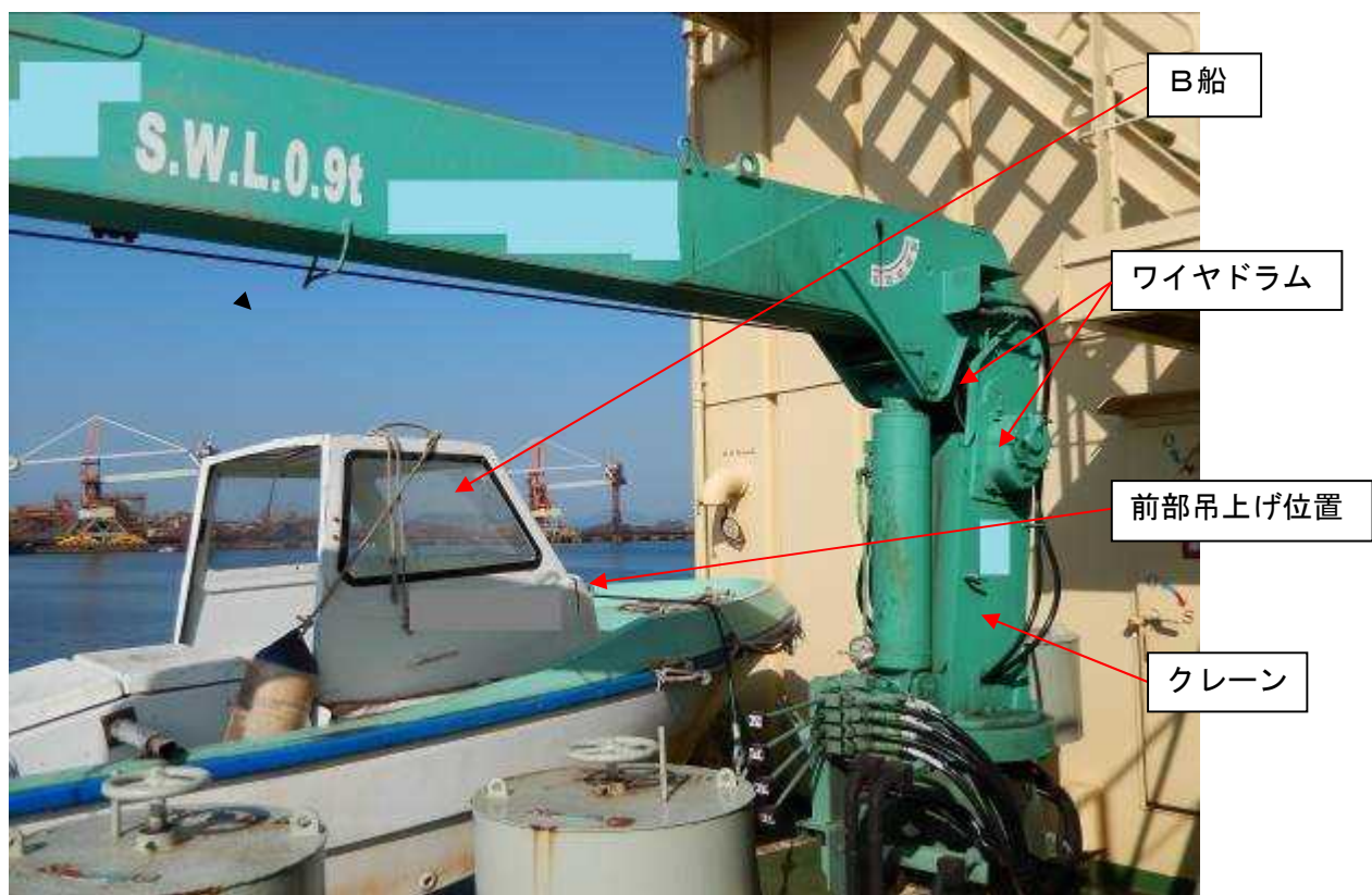
写真1 B船及びクレーン
