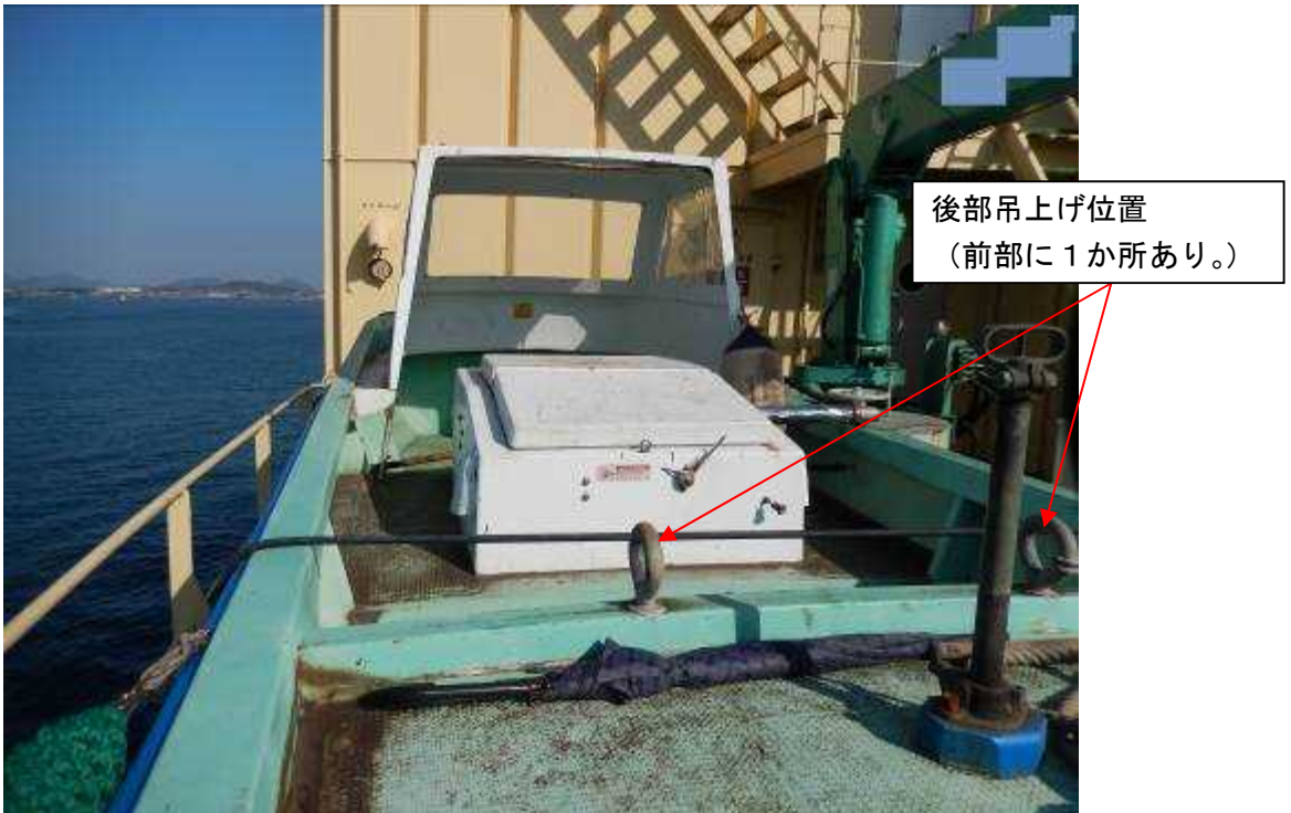
写真5 B船吊上げ位置
