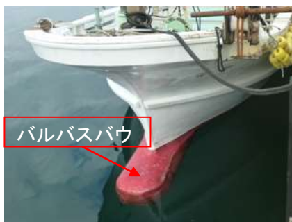
写真1 A船のバルバスバウ 写真2 B船の破口及び凹損
