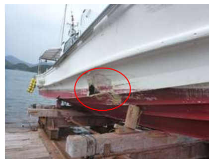
写真1 A船のバルバスバウ 写真2 B船の破口及び凹損
