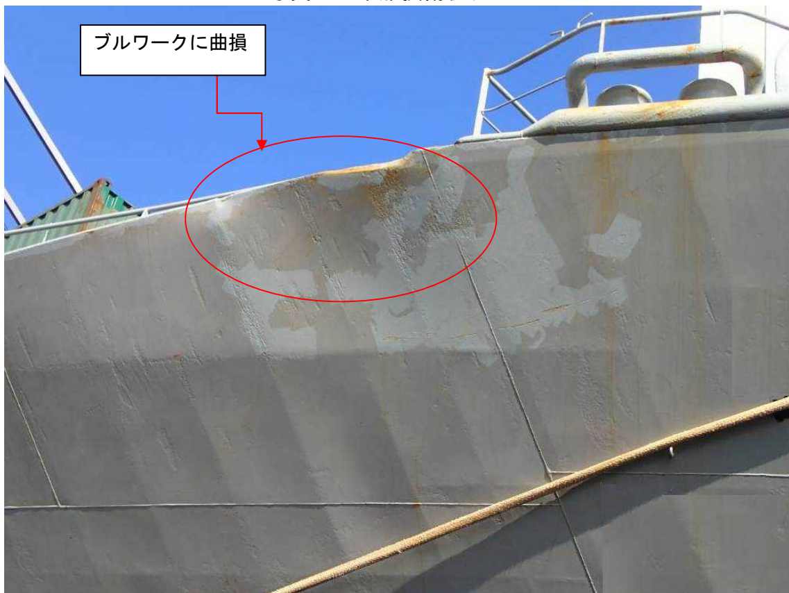
写真1 本船損傷状況
