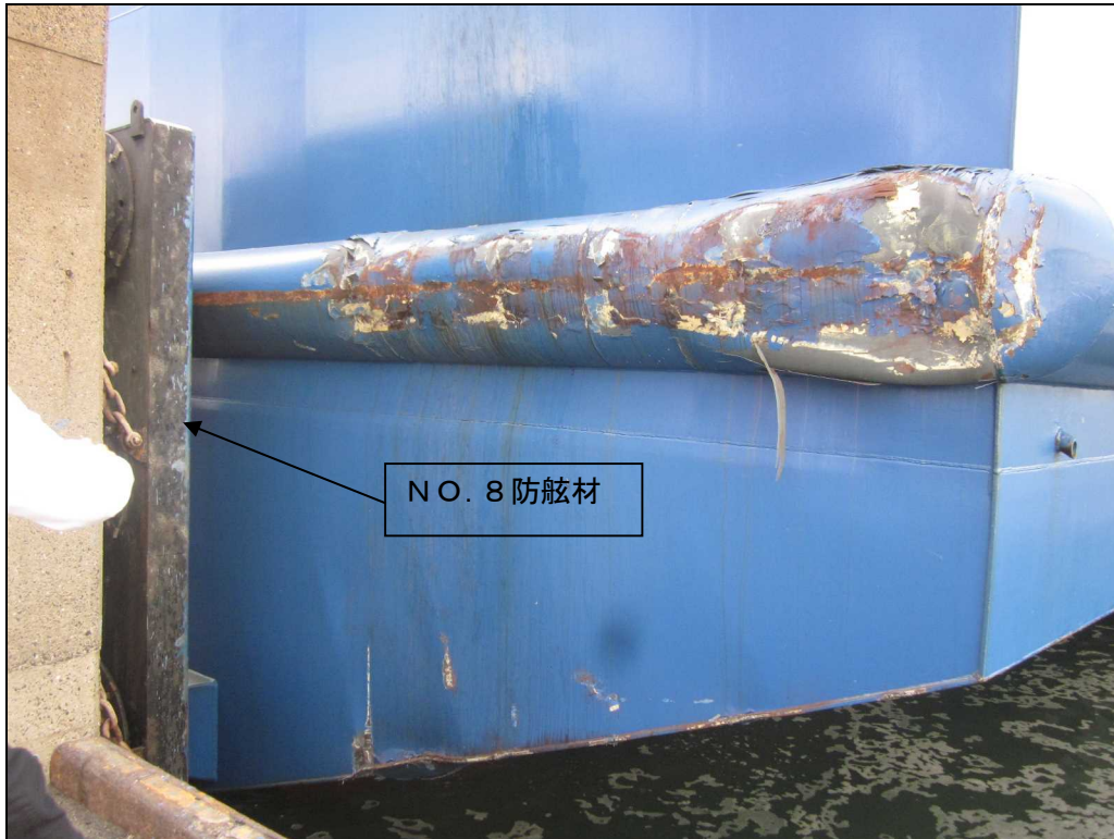
写真3 右舷船尾の損傷状況
